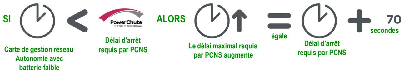
2. Pour un onduleur avec des groupes de sorties, le **Délai de mise hors tension** du groupe de sorties qui alimente le client PCNS.
