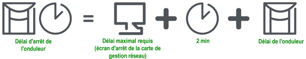
2. Pour un onduleur avec des groupes de sorties, le délai d'arrêt est égal au **Délai d'arrêt fixé** dans l'écran des **groupes de sorties** de la carte de gestion réseau (cette option n'est pas disponible pour tous les onduleurs).
